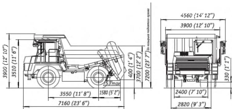
\*Габаритные размеры указаны для базовой комплектации самосвалов
